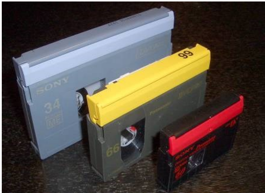
Odnosi gabarita formata BETACAM / DVCPRO / miniDV
