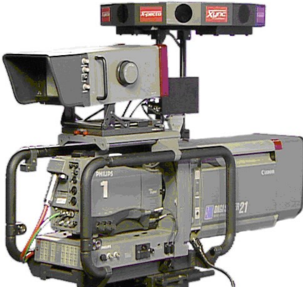
Senzor za pokrivanje studijskog prostora u virtuelnom studiju
